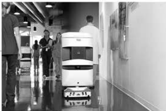
図1 病院で利用されているTUG 医薬品などを載せた多種多様なカートを引きずる。(写真：Aethon社)
